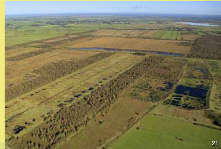
▼ Das Hartshoper Moor im September 2013. Nach dem Bau von Verwallungen und dem Verfüllen von Gräben (siehe links) ist die Mooroberfläche stark aufgequollen. Der Wasserspiegel bleibt ganzjährig auf Höhe der Mooroberfläche.
