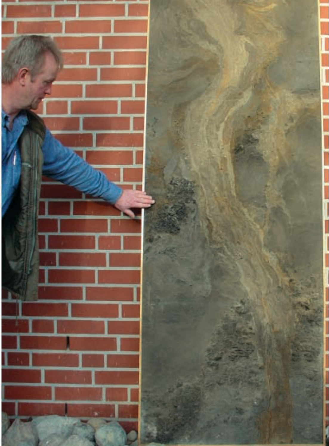
Abbildung 5: Teil eines Eiskeiles aus dem Westteil der Liether Kalkgru- be (Lackfilm). Ne- ben der „mehrpha- sigen“ Verfüllung zeigt sich eine „za- ckige“ Gestalt, die auf die besondere Struktur und Zu- sammensetzung des durchschlage- nen Materials zu- rückzuführen ist (Foto 2007, alle Fo- tos im Artikel vom Autor).
